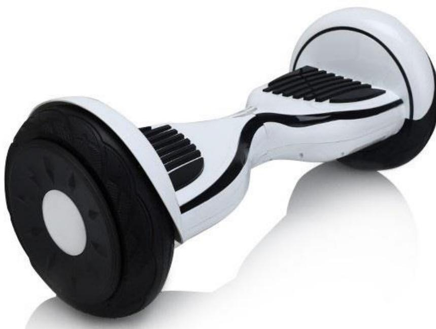
Hoverboard je balanční přesunovadlo využívající gyroskopů, které snímají náklon podložek, na kterých stojíte a dle nich udávají směr jízdy. Stačí jen správně přenášet váhu buď na špičky, nebo na paty.
