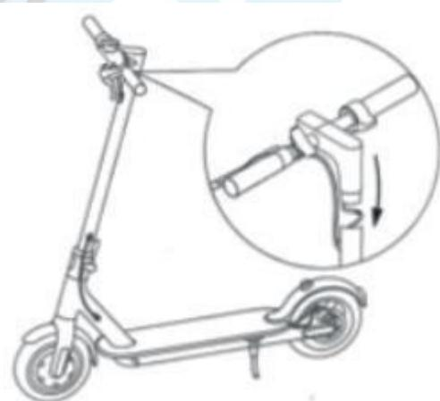
Koloběžku postavte. Více informací o skládání kloubového mechanismu najdete v 7. části. Použitě stojánek, aby koloběžka stála rovně. Nasaděte řídítka na horní část tak, aby nedošlo k poškození kabelů. Kabely je nutné pozvolna zasunout do otvoru tyče pro řídítka.
