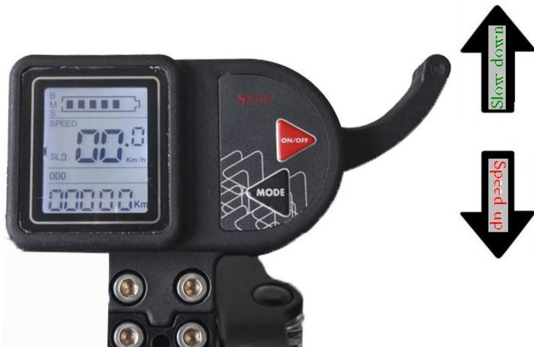
**ON / OF button** – tlačítko pro zapnutí a vypnutí, dlouhým podržením po dobu 3-5 sekund, zapnete, nebo vypnete elektrokoloběžku.
